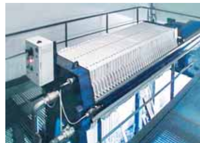
При помощи системы управления seeplex FPPU достигается оптимальная загрузка фильтр-пресса эксцентриковыми шнековыми насосами seeplex .
