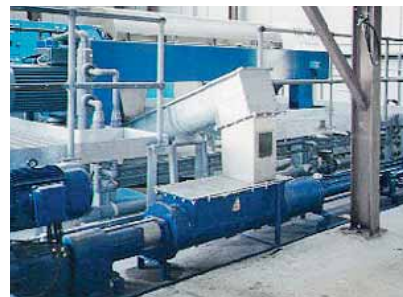
Насос seerex TENS 17-48. Продукт: обезвоженный шлам из центрифуги с 20 - 25% сухого остатка.
