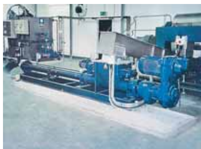
Насосы seerex BTI 17-48. Продукт: обезвоженный шлам из центрифуги с примерно 25% сухого остатка.
