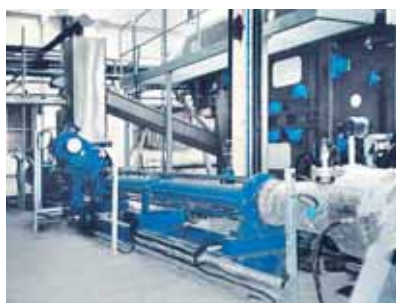
Насос seepex TINS 35-48 . Продукт: обезвоженный шлам с 20% сухого остатка из ленточного сетчатого пресса.
